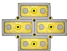
Rozmístění hmoždinek a lepidla při počtu 5 ks na m 2
